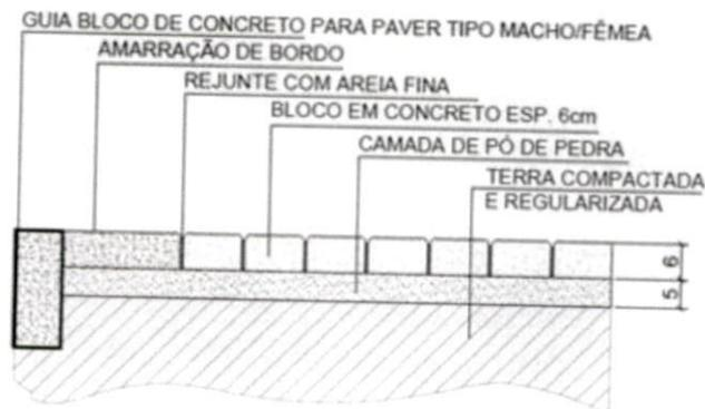
Figura 8 - Bloco de concreto, detalhe assentamento
